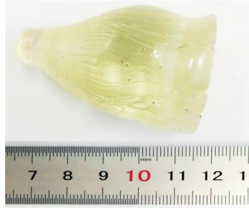
图 1 \text{Yb}:\text{GdScO}_3 单晶照片
